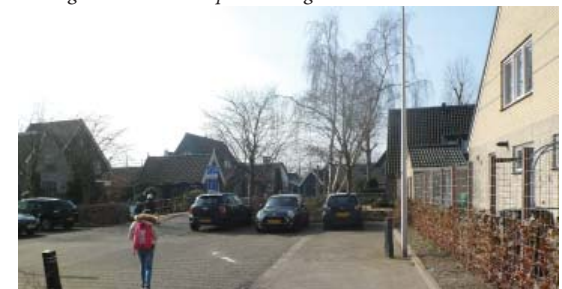
Ongelukkige positie lichtmast, op aanrijgevoelige locatie maakt vervolgens aanvullende palen nodig.
